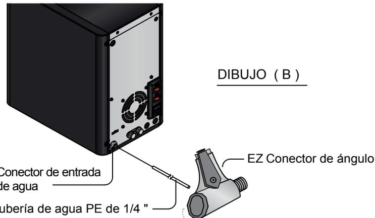
2- Conecte la línea de agua PE de 1/4 "entre el EZ conector de ángulo y el conector de entrada de agua en la parte posterior de su H2O-PRO.
