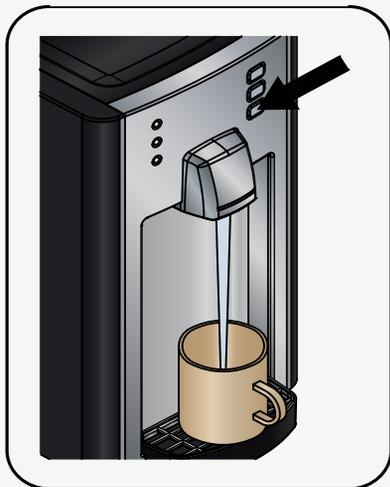
1 - Después de conectar la línea de agua, conecte el enfriador de agua a una toma de corriente. Presione cualquier botón de agua para comenzar a llenar los tanques de agua. Espere al menos 5 minutos, antes de presionar el botón de agua caliente, para verificar que se esté dispensando el agua. **NO CONECTE EL INTERRUPTOR DE ALIMENTACIÓN DE AGUA CALIENTE HASTA QUE EL AGUA SE DERRAME DEL BOTÓN DE AGUA CALIENTE.**
